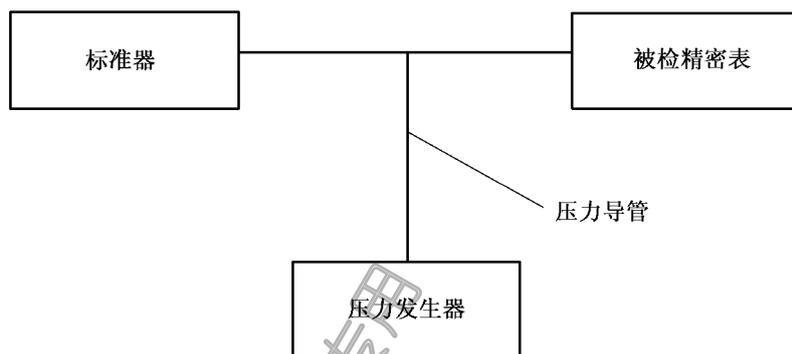
图1 精密表示值检定连接示意图
