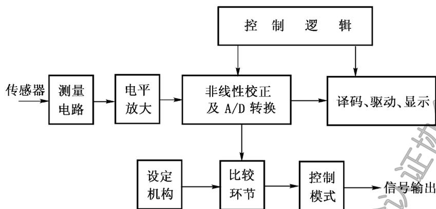
图 1 数字温度指示调节仪原理框图
