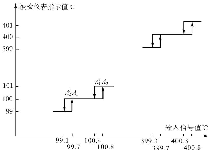
图 7 两个被检点（100 °C 和 400 °C）的检定情况
