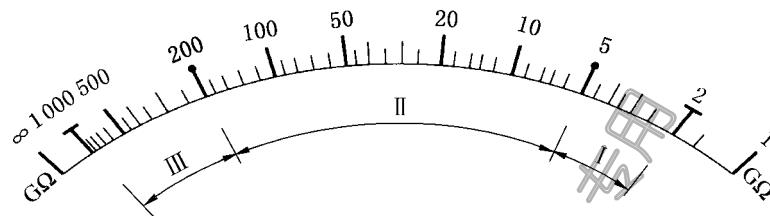
图2 指针显示绝缘表量程区段
