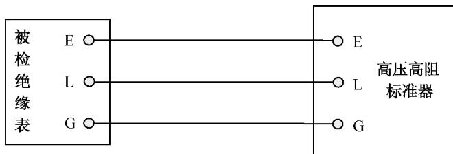
图 3 示值误差检定接线图
