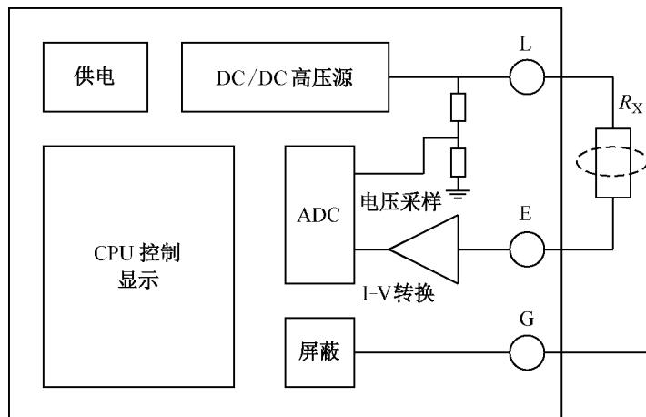
图 1 绝缘表基本原理框图
